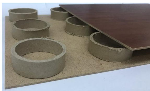
Рис. 2. Расположение частей картонных гильз во внутреннем слое плитного материала
