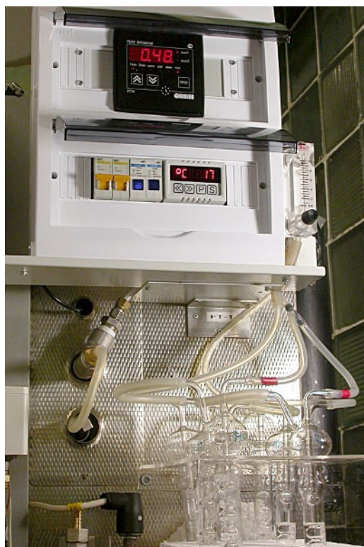
Рисунок 2 — Общий вид устройства отбора проб воздуха из камеры.
